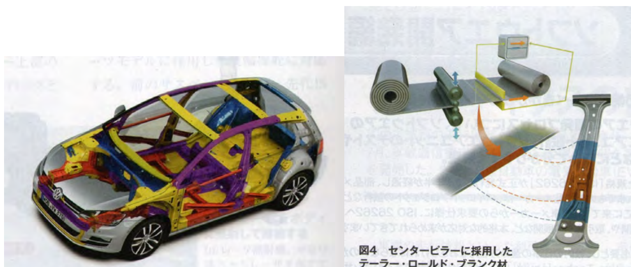
図 34 新型ゴルフの軽量化車体 MQW 例 (41) (Automotive Technology2013, 9月号より)
